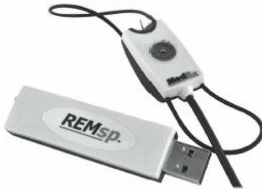
تصویر ۲. نمونه‌ای از دستگاه پروب میکروفون پرتابل، فلش نشان داده شده در تصویر به کامپیوتر متصل می‌گردد و مازول دیگر که دارای لوپ است، بر روی گوش قرار می‌گیرد. (MedRX)
