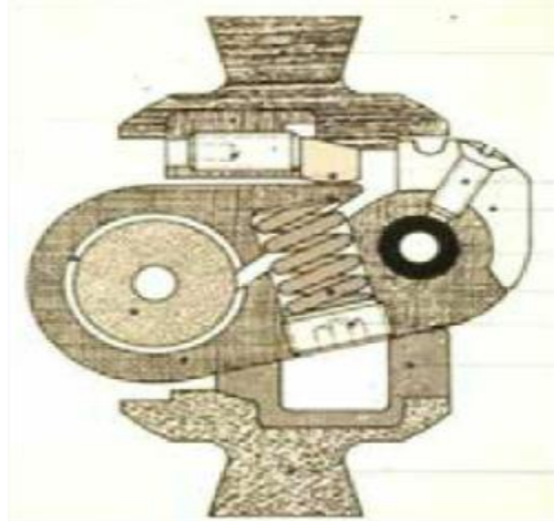
شکل ۱۱. تصویر شماتیک از نمای عرضی زانوی ایستایی کنترل فعال شونده با وزن بدن.
